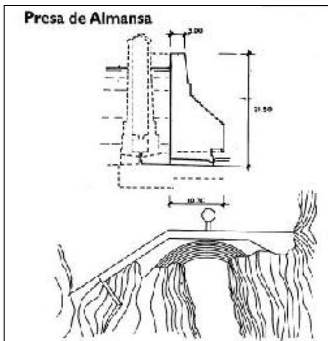
*Figura 1. Presa de Almansa. Planta y sección.
