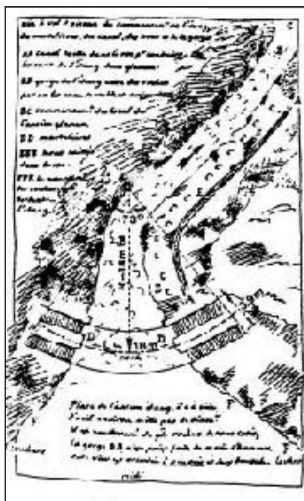
*Figura 4. Azud romano de Rémy-en-Provence, con relleno de tierra (según Schnitter).*
